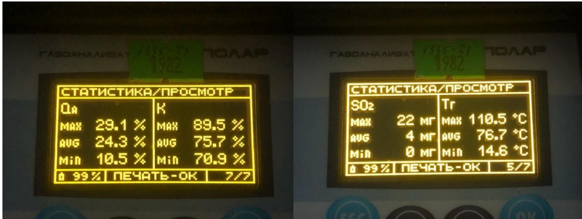
Рисунок 5. Снятие показаний с прибора непрерывного контроля выбросов
