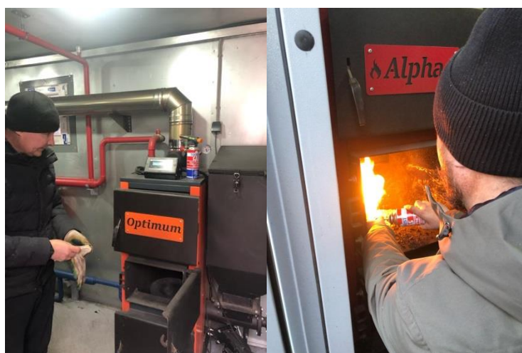
Рисунок 4. Тестирование марок топлива на экологическом стенде
